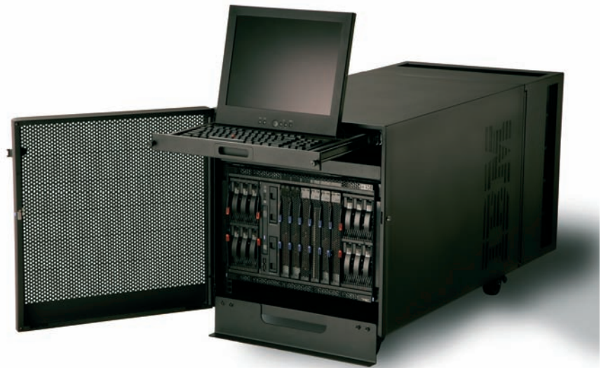
Mit dem Office Enablement Kit ist Ihr BladeCenter S umgehend einsatzbereit. Die Abbildung zeigt das optionale 1U-Fach für Monitor/Tastatur.
